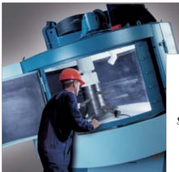
Fig. 14: Mezcladora Eirich con recipiente de mezclado inclinado
