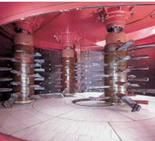
Fig. 25: Mezcladora de funcionamiento continuo para mineral de hierro, con un volumen útil de 6000 litros
